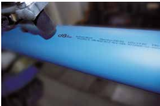
Fot. 24. Rura dBlue - w trakcie znakowania
